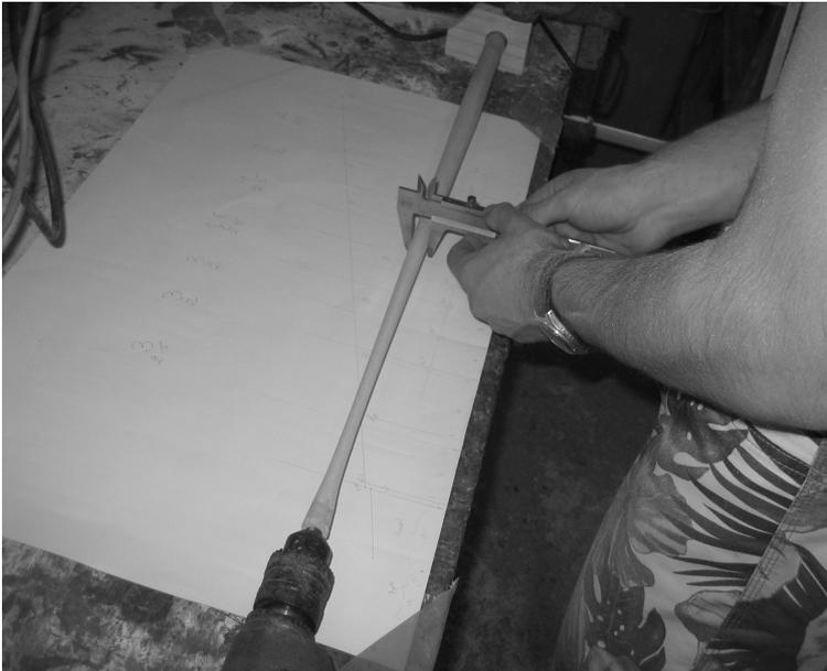
*Ci-contre : Le diamètre du mandrin se contrôle facilement au pied à coulisse*
