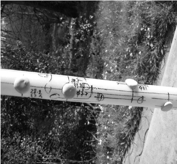
*Les bosses en mastic époxy sont collées sur le tube à l'emplacement des trous latéraux. Ici, les trous latéraux ne sont pas encore percés.*
